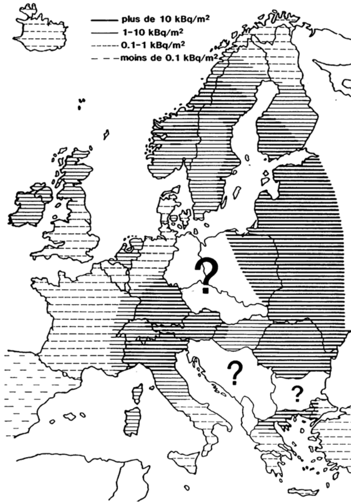
Dépot total de césium en Europe après l'accident de Tchernobyl en kBq/m 2 .
